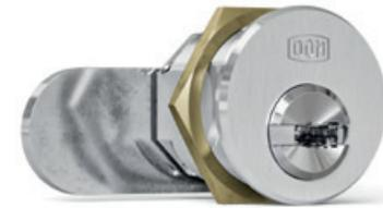
Hebelzylinder werden z. B. zum Verriegeln von Stahltüren eingesetzt. Der angebrachte Hebel wird durch den Schließvorgang betätigt und fungiert als Bolzen. Anwendungsbereich: Briefkästen, Schließfächer, Tresore, Kästen, Garderobenschränke, Inspektionsklappen, Verkaufsautomaten, etc.
